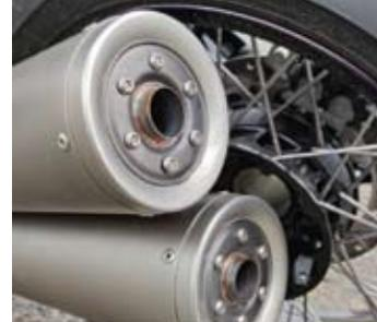
sätze sind im Schalldämpferausgang geschraubt und mit Schweißpunkt gesichert.
