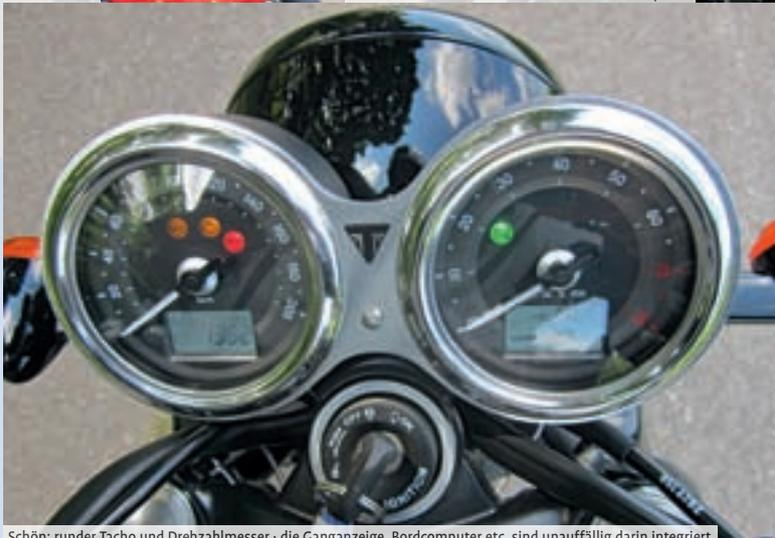
Schön: runder Tacho und Drehzahlmesser · die Ganganzeige, Bordcomputer etc. sind unauffällig darin integriert
