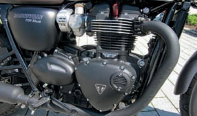
Druckstarker Motor mit modernster Einspritztechnik – obwohl es nach alter Vergasertechnik aussieht
