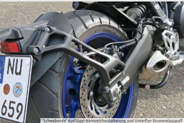
"Schwebende" Kotflügel-Kennzeichenhalterung und Unterflur-Stummelauspuff
