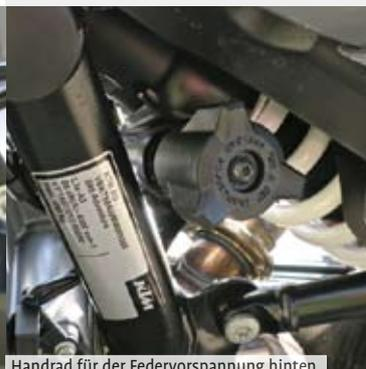
Handrad für der Federvorspannung hinten
