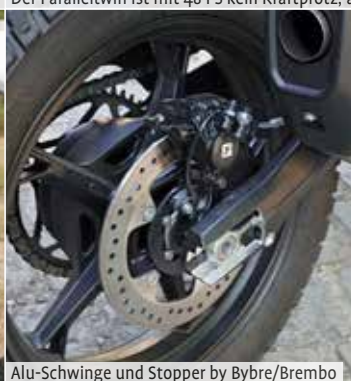
Alu-Schwinge und Stopper by Bybre/Brembo
