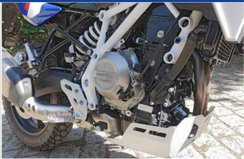
Der Paralleltwin ist mit 48 PS kein Kraftprotz, aber dafür mit "Easy Ride Clutch" sehr komfortabel
