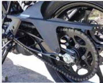
Wertige Aluschwinge mit Kettenantrieb
