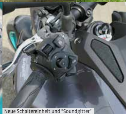
Neue Schaltereinheit und "Soundgitter"
