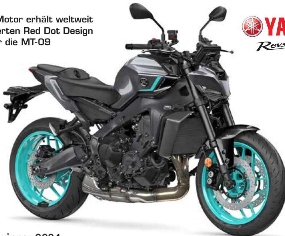
Neue Lampenmaske mit LED-Beleuchtung
