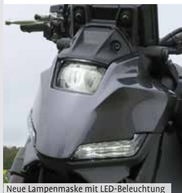
Neue Lampenmaske mit LED-Beleuchtung
