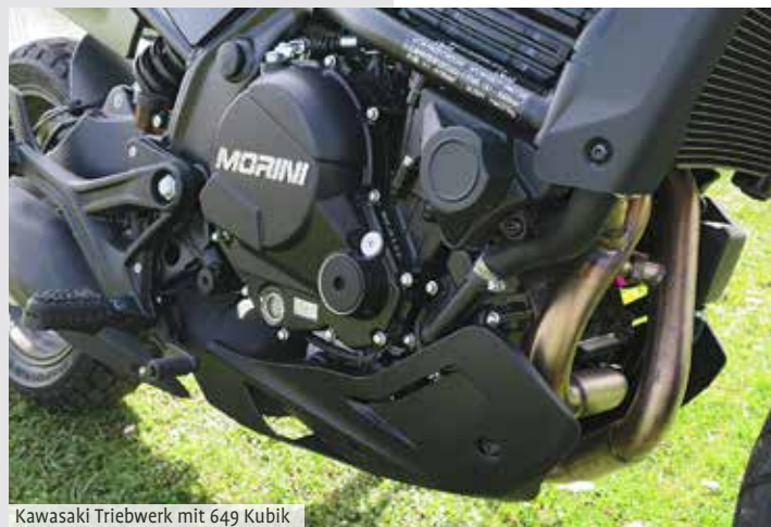
Kawasaki Triebwerk mit 649 Kubik
