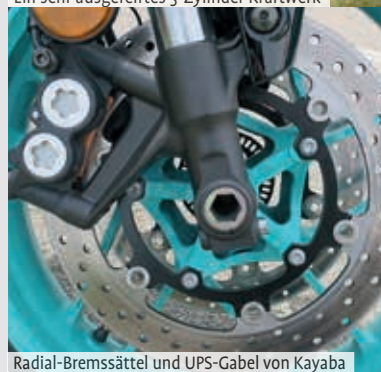
Radial-Bremssättel und UPS-Gabel von Kayaba
