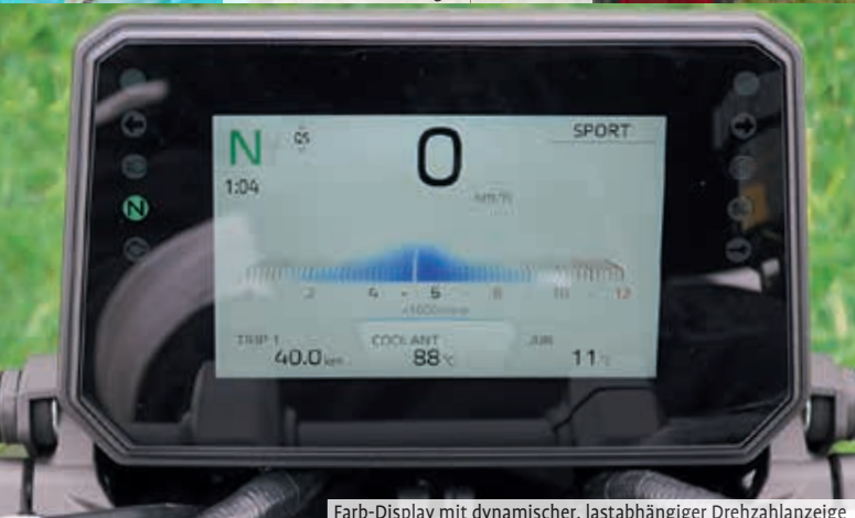
Farb-Display mit dynamischer, lastabhängiger Drehzahlanzeige
