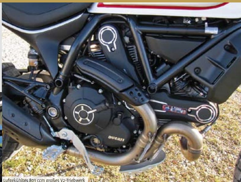
Luftgekühltes 803 ccm großes V2-Triebwerk
