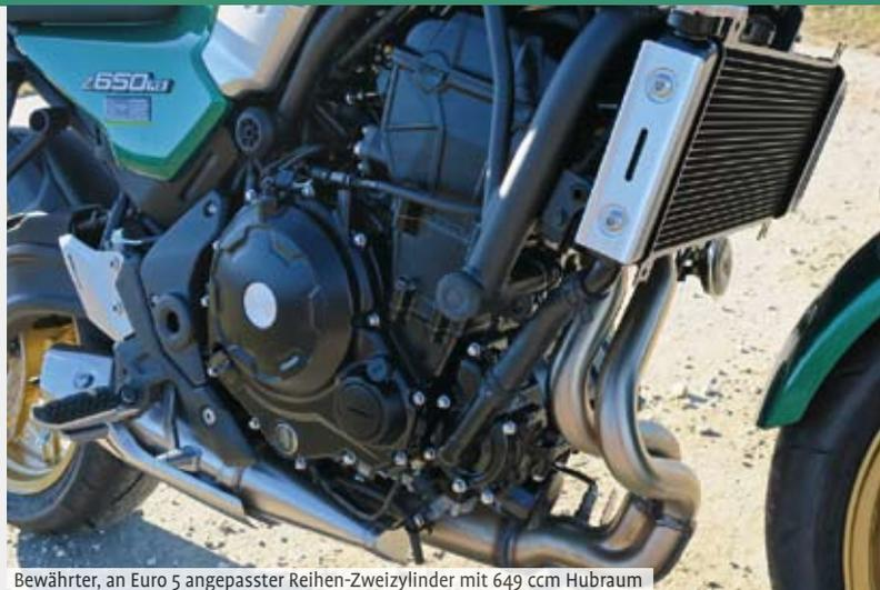
Bewährter, an Euro 5 angepasster Reihen-Zweizylinder mit 649 ccm Hubraum
