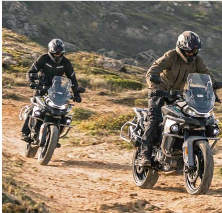
Mit der 800 MT bringt CF Moto nicht nur seine erste Reiseenduro auf den Markt, sondern auch seine bislang hubraumgrößte Maschine. Der Reihenzweizylinder mit 75 Grad Hubzapfenversatz mobilisiert 91 PS (67 kW). Als Höchstgeschwindigkeit gibt der Hersteller 195 km/h an. Bestückt ist die 800 MT vorne mit einem 19-Zoll-Rad in einer USD-Gabel, die Federung ist voll einstellbar. ABS und Traktionskontrolle kommen von Bosch und sind dank Sechs-Achsen-Sensorik kurvenoptimiert.
